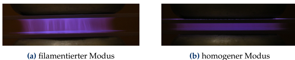
Abbildung 2.10: Photographien einer DBD im filamentierten bzw. homogenen Modus, wobei der Modiwechsel durch eine Reduktion des Gasspaltes von (a) 8 mm auf (b) 4 mm erfolgte. Beide Elektroden sind jeweils mit einem Glas-Dielektrikum (2 mm) vom Gasvolumen (Luft bei Atmosphärendruck) getrennt, die Anregung erfolgt über einen unipolaren ns-Pulsgenerator ( f = 500 \text{ Hz} ); aus Tao et al. 52 .
